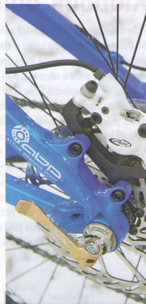
Umístěním čepu přímo do osy zadního kola je dosaženo nezávislosti funkce odpružení na práci brzdy, přitom tuhost zadní stavby ani v nejmenším netrpí
